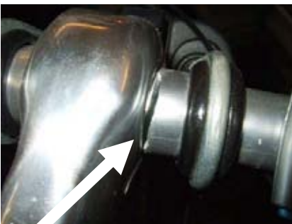
Gut zu erkennen: die Bruchstelle neben dem Lenkervorbau
